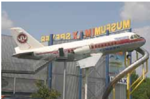
Fokker VFW-614 museon sisäänkäynnin vieressä. Tämän konetyypin viimeinen lentävä edustaja tavattiin aiemmin Schwerin-Parchimissa, teki siellä läpilaskuja. Huomaa erikoisen moottorin kiinnitys siiven päällä. Koneen nokan vierestä lähtee metalliputki-liukumäki, jota oli mukava käyttää alastuloon portaiden sijaan.
